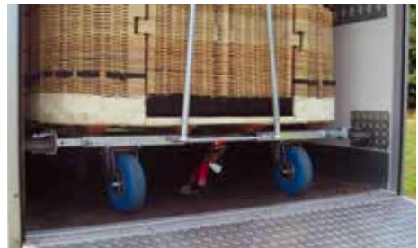
Kombination aus Kraft- und Formschluss
