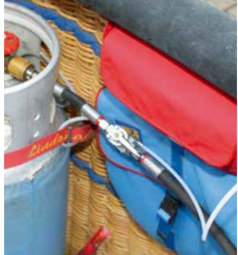
Sicheres Ableiten des austretenden Gases
